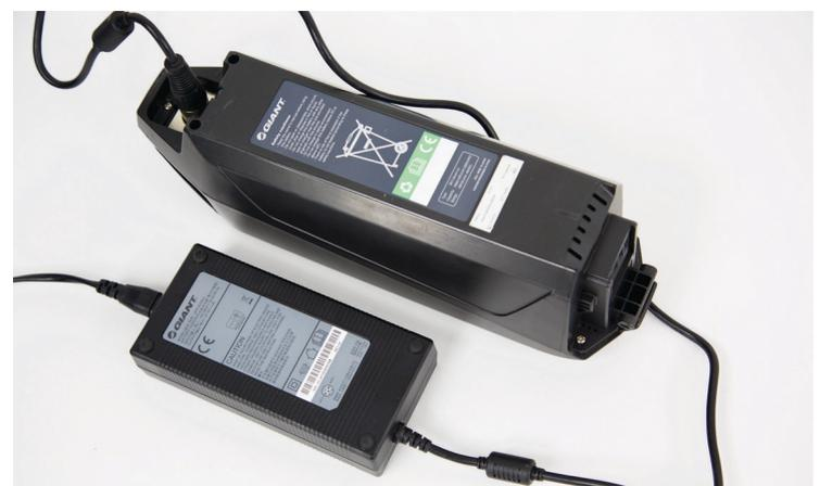
**RECHTS** Wie gewohnt ist *Giant* bei der Beschriftung seiner Batterien und Ladegeräte immer vorbildlich unterwegs - sie lassen sich eindeutig zuordnen. Unpraktisch ist, dass die Batterie nur im herausgenommenen Zustand geladen werden kann, denn der Ladegerätestecker befindet sich auf der Unterseite der Batterie. Aufgrund der engen Platzverhältnisse erfordert das Herausnehmen des Akkus etwas Übung.
