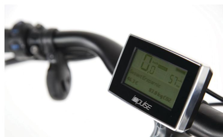
RECHTS Das am Lenker fest montierte Display, das sich bequem über die nachleuchtenden Tasten der Fernbedienung bedienen lässt, ohne die Hand vom Lenker zu nehmen, hat viele praktische Funktionen. Laut der integrierten Kostenrechnung muss man mit seinem *Kalkhoff Agattu Premium* 20,707.13 Kilometer zurücklegen, bis es sich kalkulatorisch bezahlt hat, wenn man den Annahmen des Fahrradcomputers folgt.
