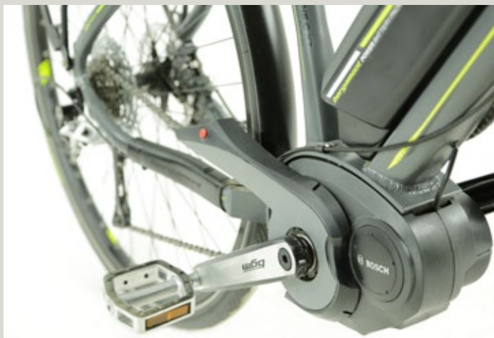
Schön gelöst: Bosch Mittelmotor mit halblangem Kettenschutz. A tidy solution: the Bosch mid motor with a half-length chainguard.
