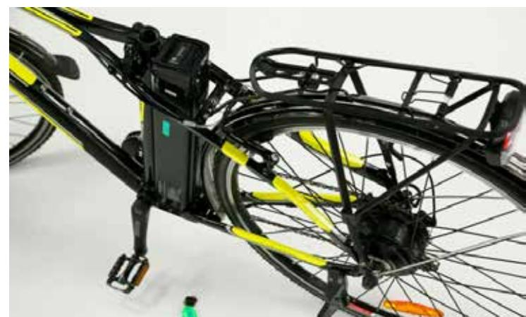
**RECHTS** Der energiereiche Akku des Agogs ist recht unauffällig hinter dem Sitzrohr versteckt. Der Akku kann, ohne ihn herauszunehmen, mit dem Ladegerät geladen werden. Dies ist die einfachste Lösung, denn um den Akku herauszunehmen, muss erst das Schloss am Tretlager geöffnet und der Sattel herausgezogen werden. Beim Test brach der Schlüssel ab, da das Pedal die Position des Schlüssels beim Rückwärtsrangenkreuzte.
