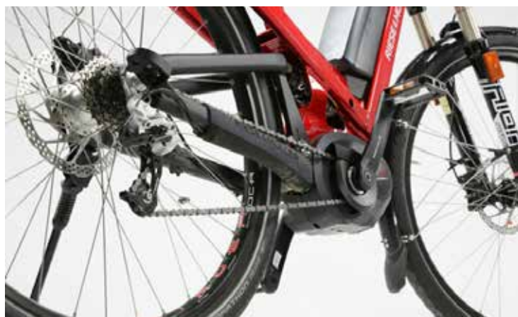
RECHTS Das Dämpfungssystem der Hinterradschwinge ist kaum sichtbar, da es unter den Blechen des Rahmenknotens weitgehend versteckt ist. Die Entfaltung über die Sram Dualdrive 3x9 Naben-Ketten-Schaltungskombination ist ausreichend und erlaubt auch das leichte Fahren ohne Antrieb. Der 400 Wh Bosch Akku sitzt etwas wie aufgesetzt im Durchstiegsbereich des Pedelecs 45 - dafür in einer vom Schwerpunkt her optimalen Position.
